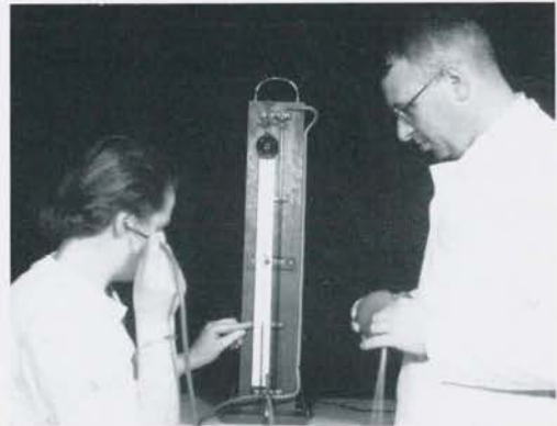
Pneumofon volgens Van Dishoeck (rechts op de foto), de voorloper van de tympanometer. "Patiënte" hoort, zoals zij aanwijst, de 50 Hz toon het beste bij een onderdruk in de gehoorgang (foto omstreeks 1935).
