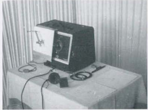
Prototype van de continue audiometer van Van Dishoeck, geïntroduceerd in 1947 en lang in gebruik geweest als screeningsaudiometer.
