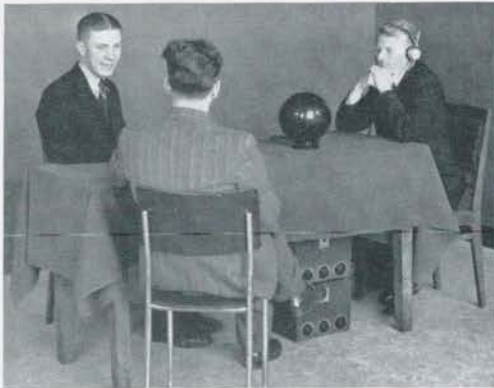
Luisterexperiment met een door Philips ontwikkeld niet draagbaar hoortoestel van hoge kwaliteit met twee telefoons en twee microfoons in een kunsthoofd waardoor richtinghoren mogelijk is.
