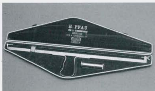
Het monochord van Struycken ter bepaling van de bovengrens van het gehoor.
